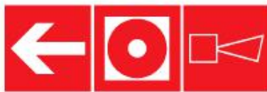
Кнопка включения установок пожарной автоматике и оповещателей налево
