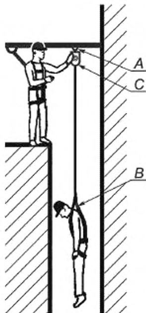
A -- анкерная точка; B -- устройство для поддержания тела (спасательная привязь); C -- подъемное спасательное устройство
