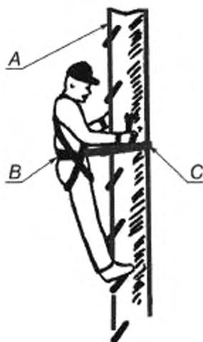
А — крепление; В — привязь; С — стrop для системы позиционирования
