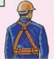
Один конец страховочного каната крепится к кольцу наплечных ремней с помощью карабина, обеспечивающего быстрый присоединение и отсоединение. Кольцо должно располагаться на уровне плеч работника. Свободный конец страховочного каната при-
